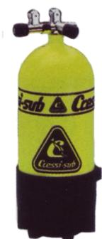
Le scaphandre est composé d'un bloc bouteille, une ("mono") ou deux ("bi"), et d'une robinetterie. La bouteille est un réservoir en acier ou en aluminium rempli d'air comprimé à une pression de service comprise entre 175 et 200 bars. Sa capacité, c'est à dire son volume intérieur peut varier de 7 à 18 litres. Couramment nous rencontrerons des blocs "mono" de 12 et 15 litres, et 2 fois 9 litres pour le "bi".
